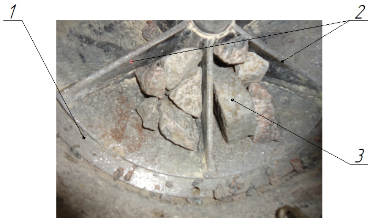
Рис. 8. Заклинивание кусков гранита между ребрами и ступицей в роторе мельницы: 1 – ротор; 2 – ребра; 3 – заклиненный кусок материала
