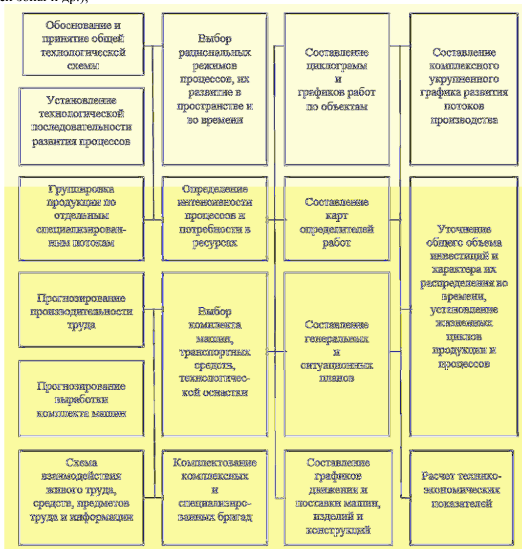
Рис. 2. Схема организационно-технологических параметров производства
