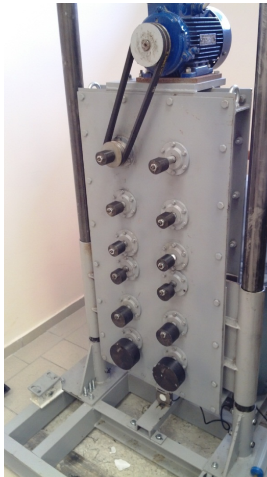
Рис. 8. Вибрационная установка в рабочем состоянии с тензометрическим датчиком силы
