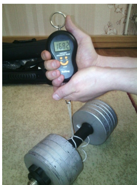
Рис. 6. Взвешивание тарированного груза для статических испытаний
